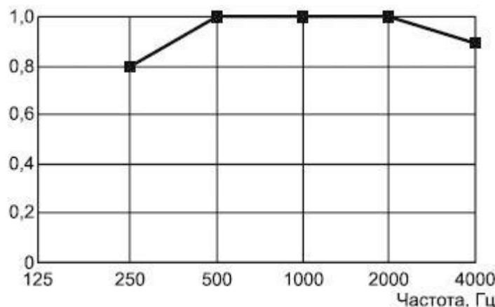
Рисунок В.1 - Нормативная кривая для определения индекса звукопоглощения  $\alpha_w$
